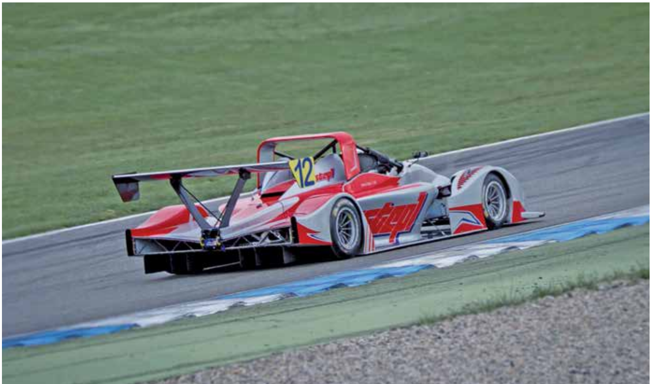
Das ursprüngliche Heckflügelssystem hatte einen V-förmigen Halter. Dieser nahm den Flügel an der Saugseite auf.
