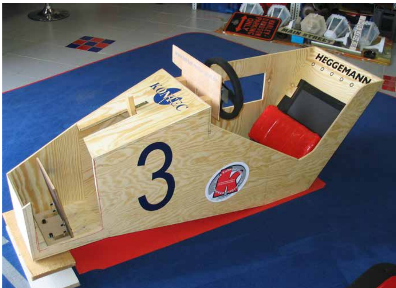
Mit dem ersten Chassis-Prototypen aus Holz wurden Sitzposition und Ergonomie überprüft und abgestimmt.
