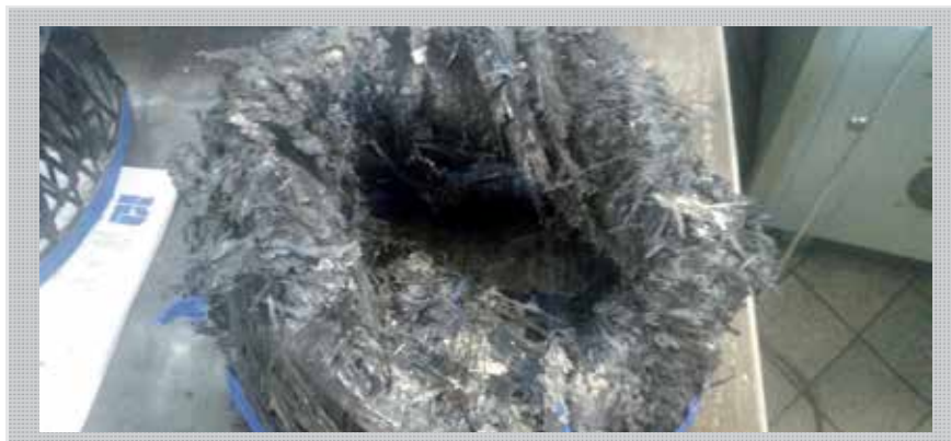
Gecrashter Probekörper zur Validierung des Kraft-Wege-Diagramms.
