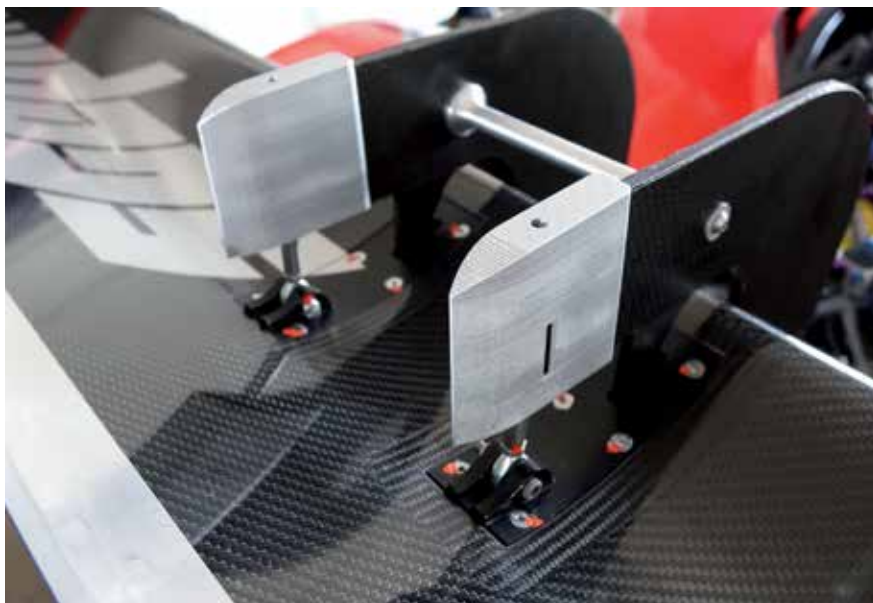
Durch die Öffnung kann der Flügel mittels Inbusschlüssel verstellt werden.
