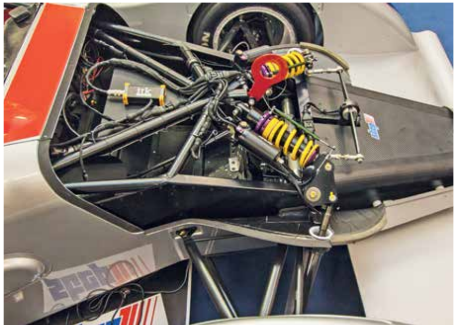
ITK positionierte den vorderen Messwertaufnehmer in der Fahrzeugfront.
